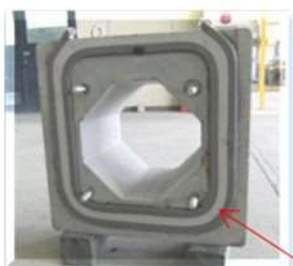
供試体の断面 (写真は注入工法) 高弾性接着剤 (TBボンド)
