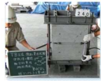
軸方向変位試験の状況 追随性を確認！はがれなし！
